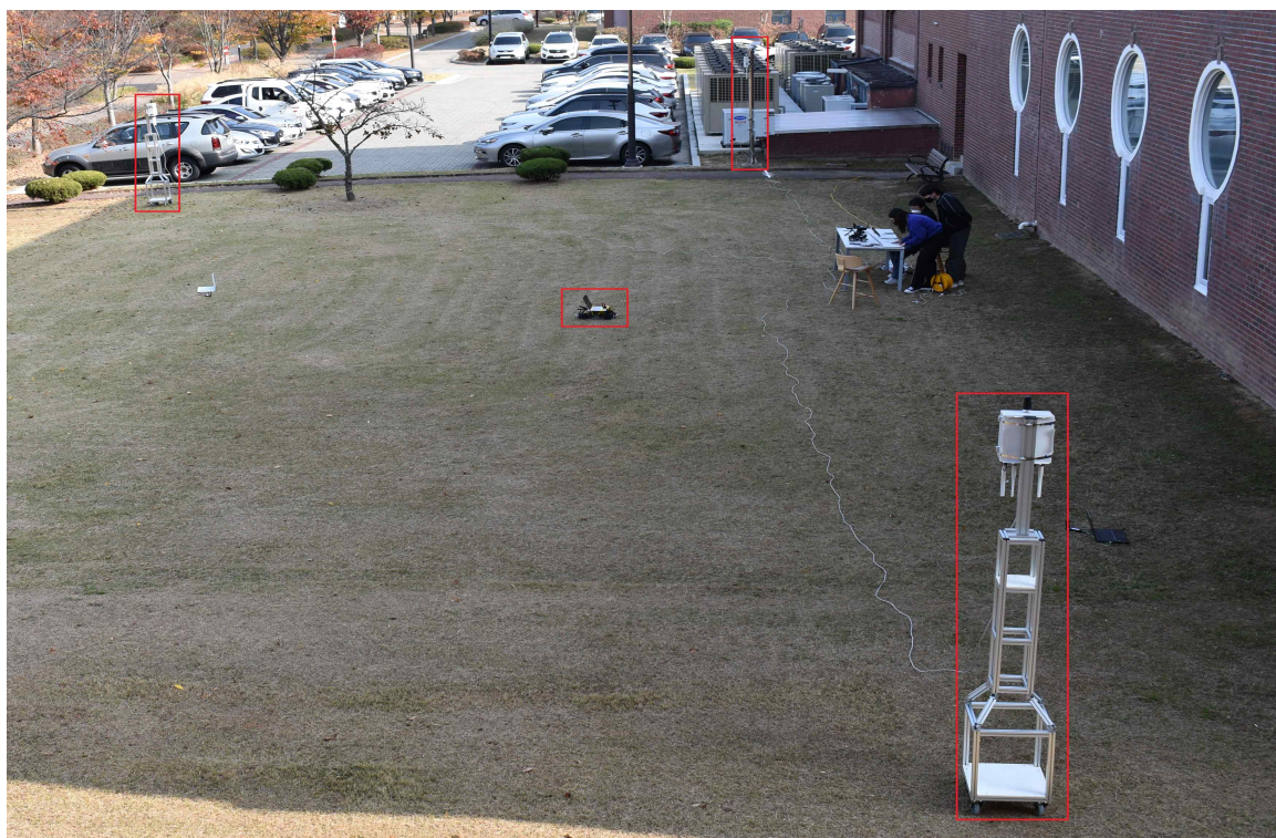
▲ RSU (3개소)와 OBU (모형이동체)를 활용한 Hybrid-V2X ToF 기반 측위 검증 장면
