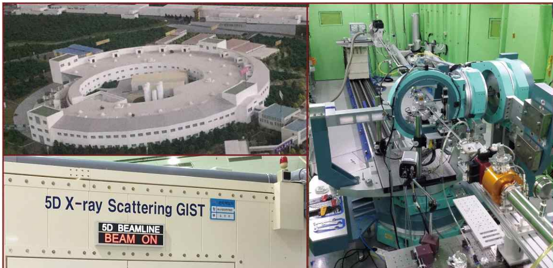
▲ 포항 방사광가속기에 구축된 지스트 전용빔라인: X-선을 활용, 물질의 극미세 초고속 현상을 관찰하기 위한 장비
