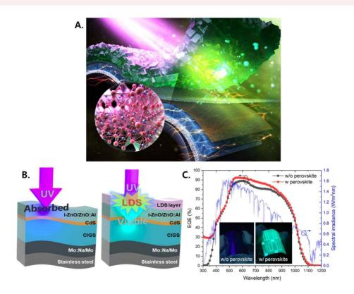
그림 A. 페로브스카이트를 이용해 자외선 영역의 태양광을 가시광선으로 변환(luminescent down-shifting, LDS)시켜 추가적인 전기에너지를 생산하는 CIGS/페로브스카이트 하이브리드 유연박막태양전지 모식도.
