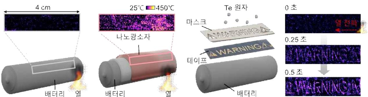
▲ **배터리 표면 온도 분포 시각화**: 다양한 형태로 패터닝된 나노광소자를 활용하여 배터리의 온도 분포 및 열 전파 실시간 모니터링.
