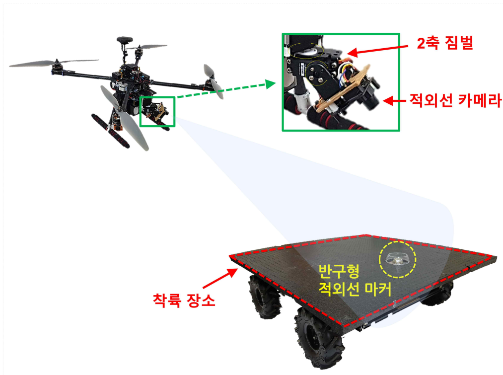
그림 1. 드론의 짐벌에 장착된 적외선 카메라가 반구형 적외선 마커를 탐지하는 모습. 반구 형태의 적외선 마커는 측면에서도 탐지가 가능하기 때문에 드론이 어느 방향에서 자동차에 접근하여도 추적하여 착륙할 수 있음.
