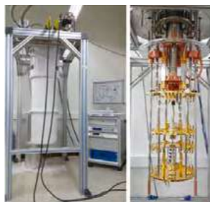
극저온(7mK) 고자기장(9 Tesla) 장치
