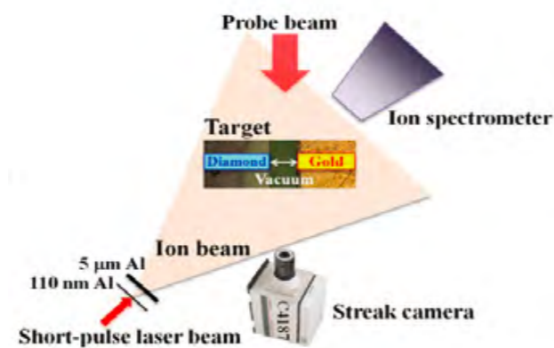
고출력 레이저를 이용해 만든 이온들로 작은 표본을 급격히 가열하는 기술의 예
