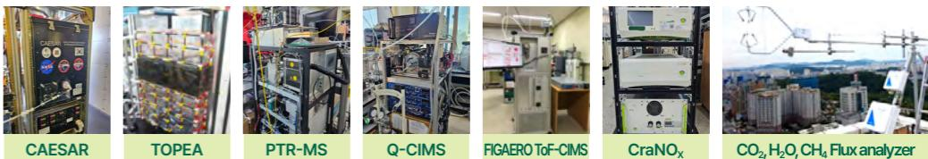
오염 물질 농도 (NO<sub>x</sub>, NO<sub>2</sub> (HONO, NO<sub>3</sub>, N<sub>2</sub>O<sub>5</sub>, PNs, ANs, PAN, HNO<sub>3</sub>), VOCs, Halogen species, 입자상 oVOCs), 오염 물질 플러스, 대기 오염도 실시간 측정.
