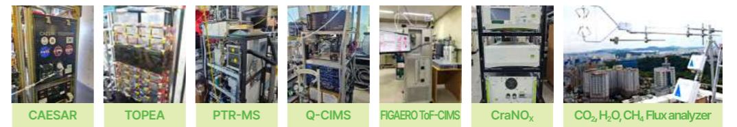
오염 물질 농도 (NOx, NO2 (HONO, NO3, N2O5, PNs, ANs, PAN, HNO3), VOCs, Halogen species, 입자상 oVOCs), 오염 물질 플럭스, 대기 오염도 실시간 측정.
