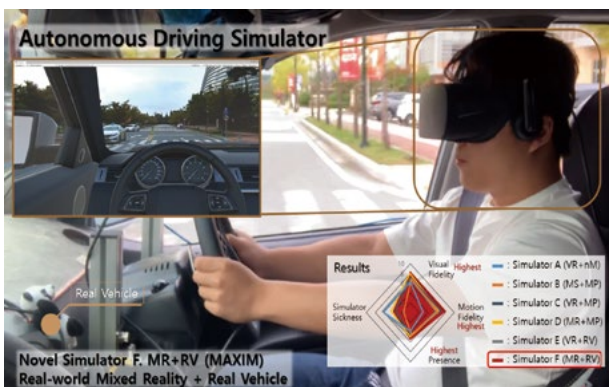
그림 1 (연구1) 시각적·움직임 사실감과 현존감이 가장 뛰어난 실차 기반 혼합 현실 자율주행 시뮬레이터의 모습
