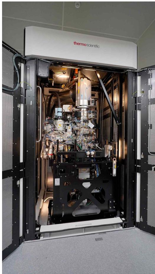
▲ 중앙기기연구소(GAIA)에 국내 10번째로 설치된 최첨단 300kV(킬로볼트) 고분해능 초저온 투과전자현미경(300kV Cryo-EM)
