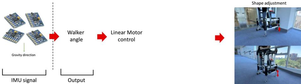
▲ 개발된 인공지능 보행 보조 로봇의 속도 제어 및 형태 변환 소프트웨어와 그 동작 모습. 촉각 센서 정보를 인공지능 모델로 학습시켜 워커가 의도한 가속을 할 수 있도록 회전 모터를 제어한다. 관성 센서 기반으로 워커가 현재 기울어진 정도를 감지하고 수직 모터를 통해 형태를 변환시켜 워커가 경사로에서도 평행을 유지할 수 있도록 한다.
