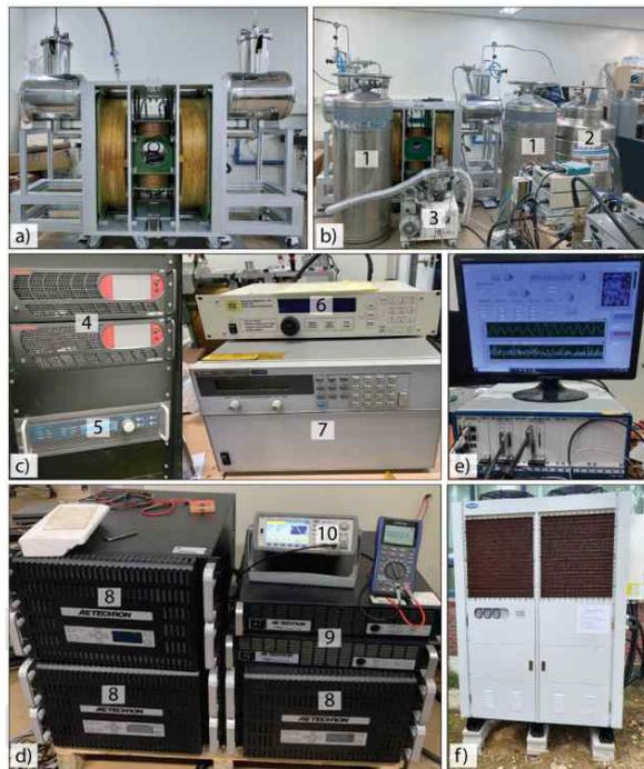
▲ **인체에 적용가능한 초전도체 코일 기반 AM-MPI20 장치**: a) MPI 정면, b)MPI 장치와 냉각 장비 전체 구성, c) 직류파워서플라이장치(집중 코일, 초전도체 코일 충전용), d) 파형발생기(Function generator) 및 파워증폭장치, e) 컴퓨터 인터페이스장치, f) 냉각 장치 : 1, 2, 3 장비를 통해 초전도체 코일을 냉각시키고, 그 과정에서 진공상태를 유지하도록 함. 4, 5, 8, 9 장비를 통해 전자기코일을 충전하고, 6, 7 장비를 통해 초전도체 코일을 충전함. e, 10 장비를 통해 전체 과정을 모니터링하고, f 장비를 통해 전자기코일을 냉각시킴.
