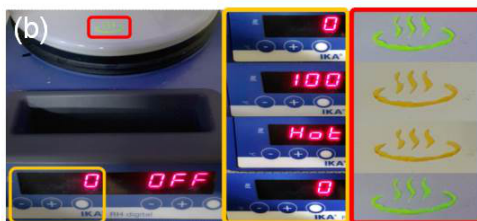
[그림 2] (a) \text{Cs}_4\text{PbBr}_6 페로브스카이트 소재의 반복적 온도 변화에 따른 발광세기 변화 (b) 전열기 위에 \text{Cs}_4\text{PbBr}_6 잉크로 프린팅 된 온천 마크의 온도에 따른 색 변화
