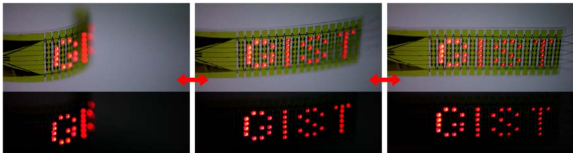
그림 4. 자가 변형 LED 디스플레이의 동작 과정
