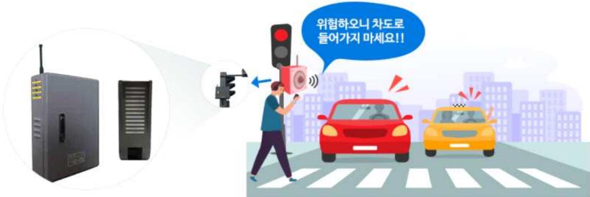
[그림] 무단횡단 예방 음성안내 장치 예시
