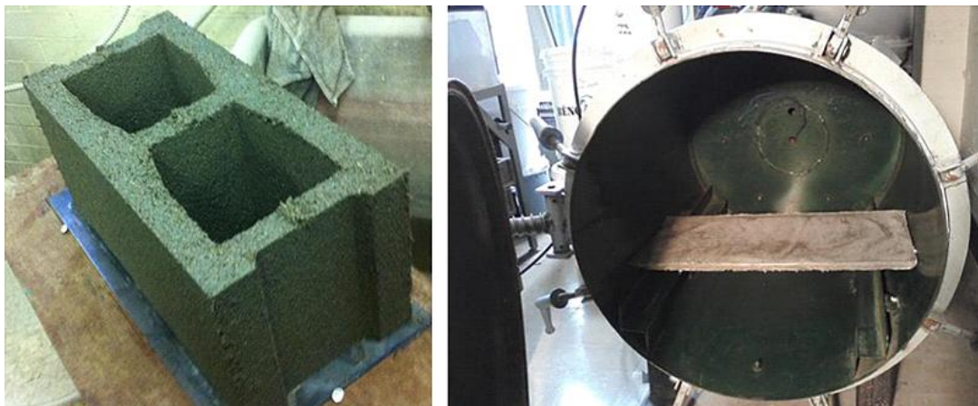
[그림 19] 이산화탄소를 활용한 콘크리트 블록
